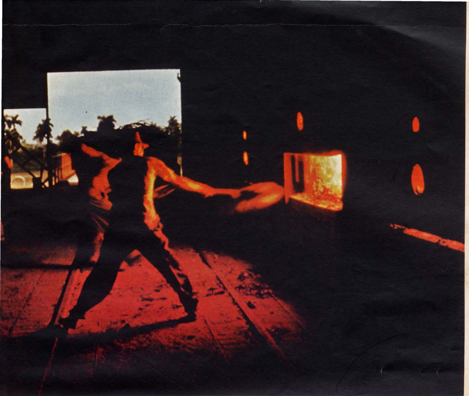
orden del fundidor, los obreros palean hacia el interior el material. La preparación del caldo es paso decisivo en la fabricación del acero. más precioso de la fundición: la salida del acero del horno para caer en el cubilote. De ahí, fríos, saldrán los lingotes para hacer cabillas.
