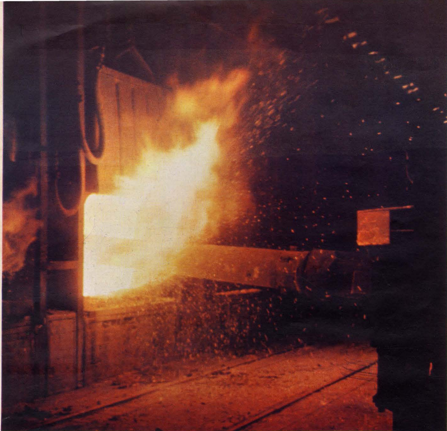
La grúa de 95 toneladas empuja dentro del horno una bañera llena de chatarra. El horno responde con una salva de calor y llamas.
