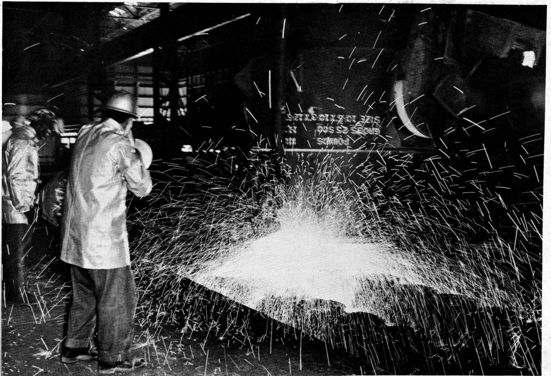
Estos técnicos observan el proceso y la grúa hace descender el cubilote sobre las dos hileras de moldes a los que va llenando lentamente. A la derecha, el campo de chatarra de la planta y la grúa que mediante un electroimán levanta con facilidad pesadas cargas de cero.
